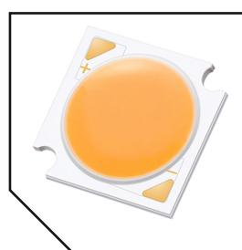
Работа при высоких температурах обеспечивается за счёт СОВ светодиодов и выносного драйвера
